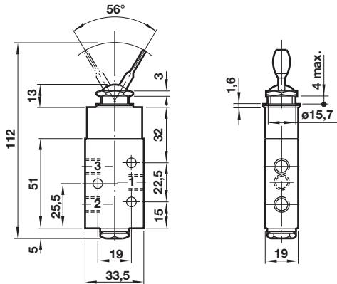
Panel hole:  $\varnothing$  16 mm
